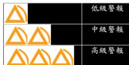
如果同時觸發多個級別的警報，則優先顯示較高級的警報，較低級的警報將保留並在較高級的警報解決後再次顯示。
