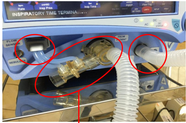
注意管路及 Flow sensor 連接
