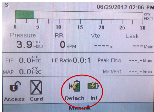
圖 4-35 可拆卸電池狀態：黃色閃電符號表示電池正在充電。整個符號為綠色時，電池為充足電量。
