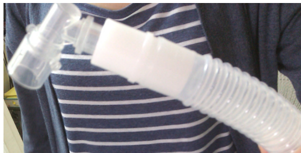
圖 4-33 白色連接管連接L型接頭，完成管路組裝。
